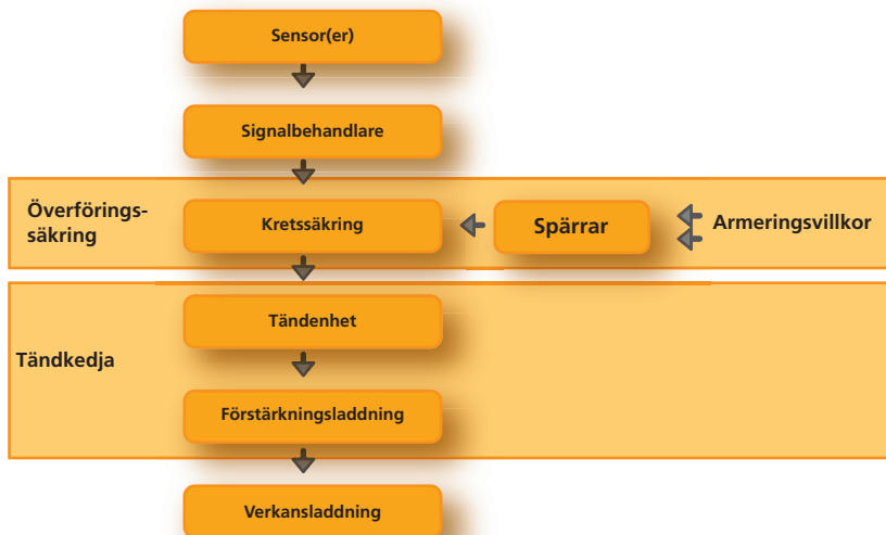
Bild 4:17 Tändsystem med obruten tändkedja ("in-line")
